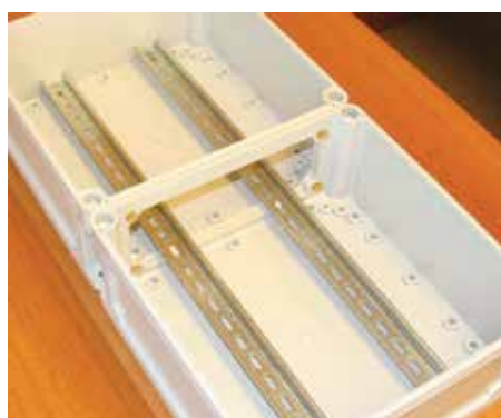
6. Стяните болтами, установите DIN-рейки
