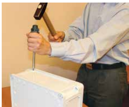
1. Удалите соединительные отверстия
