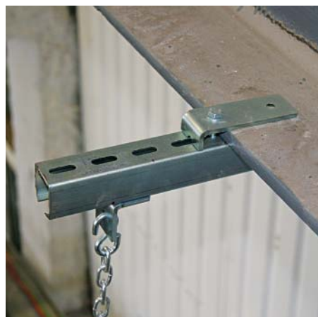
Использование С-обр. профиля для подвеса на балку
