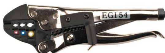
2ART54. Клеши для обжима изолированных наконечников 0,25-6 мм 2 и зачистки проводов
