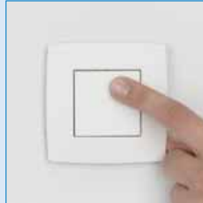
Нажмите соответствующий радиовыключатель (красный СИД и подключенная нагрузка включатся 2 раза для подтверждения)
