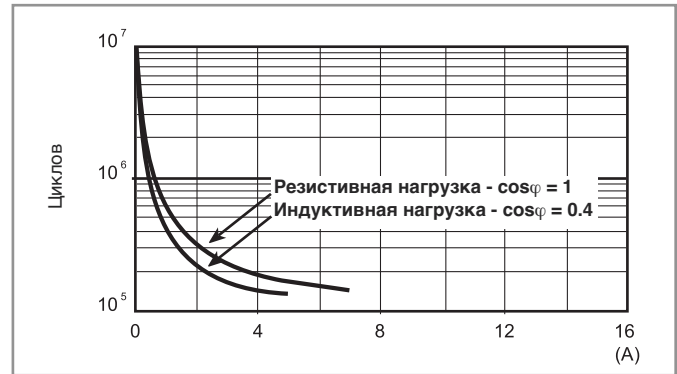
F 58 - Электрическая долговечность (АС) при ном. нагрузке, Реле с 4 перекидными контактами
