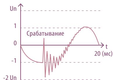
Типичная форма коммутационного перенапряжения
